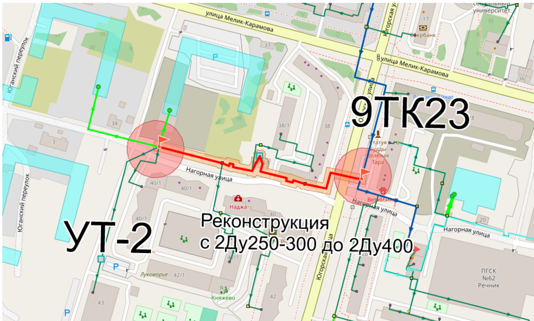
Рисунок 1.37 – Схема расположения реконструируемого участка от 9TK23 до УТ-2
